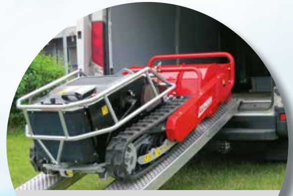
Med sin vikt på 345 kg är RC-751 enkel att transportera på en trailer eller en liten lastbil.
