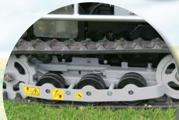
Rullarna i banden som tillverkade av metall med smorda lager, vilket ger lång hållbarhet.
