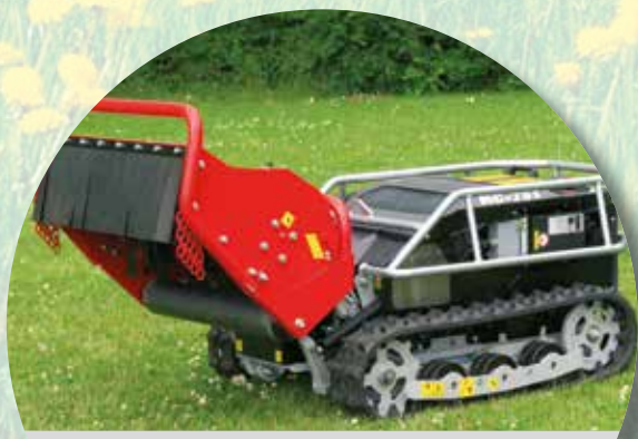
Gräsklipparen i serviceläge med bra åtkomst vid underhåll.
