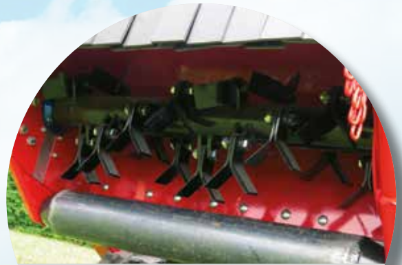
RC-751 är som standard utrustad med Y-slagor för året runt bruk.
