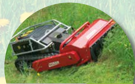
RC-751 gräsklippare för sluttningar på upp till 50°
